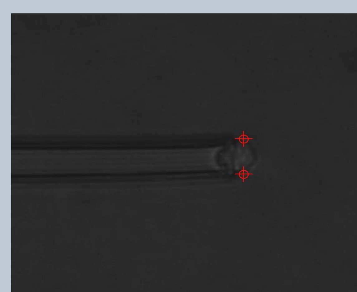
Figure 6: Localización de los puntos borde en dirección Y y posterior seguimiento con el tiempo
